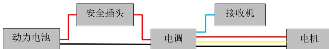
图 4：带安全插头的动力系统示意图
